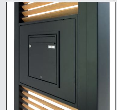
Im Seitenteil integrierter, farbig gepulverter Briefkasten aus Aluminium der Marke RENZ, 370 x 330 x 100 mm, Einwurf 335 x 33 mm, DIN 13724. Pro Seitenteil sind bis zu 8 Briefkästen möglich.
