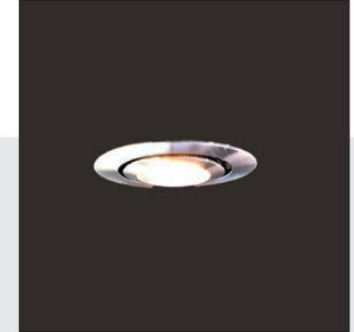
LED-Decken-/Seitenteilleuchte, einachsrig kippbar/Strahlungswinkel 45°, dimmbar, 155 lm, Verbrauch 3 Watt, Lichtfarbe Warmweiß (2.700 K), Lieferung inklusive Trafo
